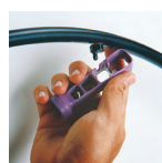
Odstranění XB kapkovače
